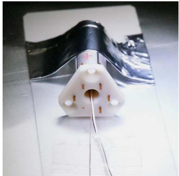
2.2.15. [EPO-TEK H74](#) をスキャナー台に盛ってケーブルを固定する。エポテックに粘度があると作業がしやすいので、ここでは古いものを使うとよい。同軸の外皮がエポテックをはじくので、この作業は盛って硬化させることを数度繰り返す必要がある。この作業には待ち時間が繰り返し発生するので次節の作業を始める。
