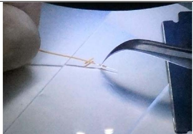
2.3.2. 2.2.4 で使ったものと同じ被覆銅線を端子 [AMP 2-330808-8](#) に [Castolin Eutectic 157](#) でハンダ付けする(1.3.4-1.3.6 参照)。同じものを5つ用意する。
