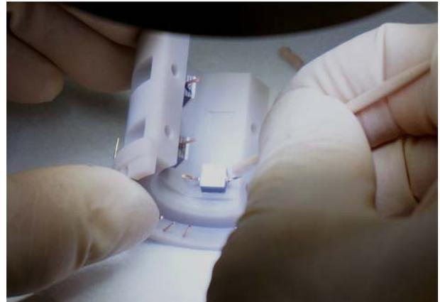
1.2.4. 押し付けた後に、積層ピエゾ素子最下部のベースプレート(分極していない)の側面にも EPO-TEK を少量盛り、滑らかな曲面になるようにする。
