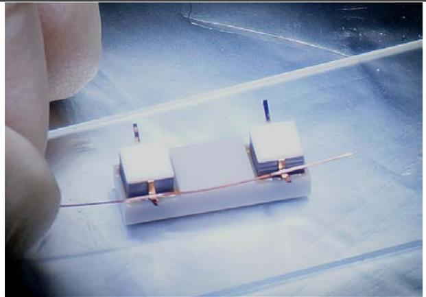
1.3.2. 銅線を電極の根元に近い方に結び付ける。コモンは3本の電極が出ている方。
