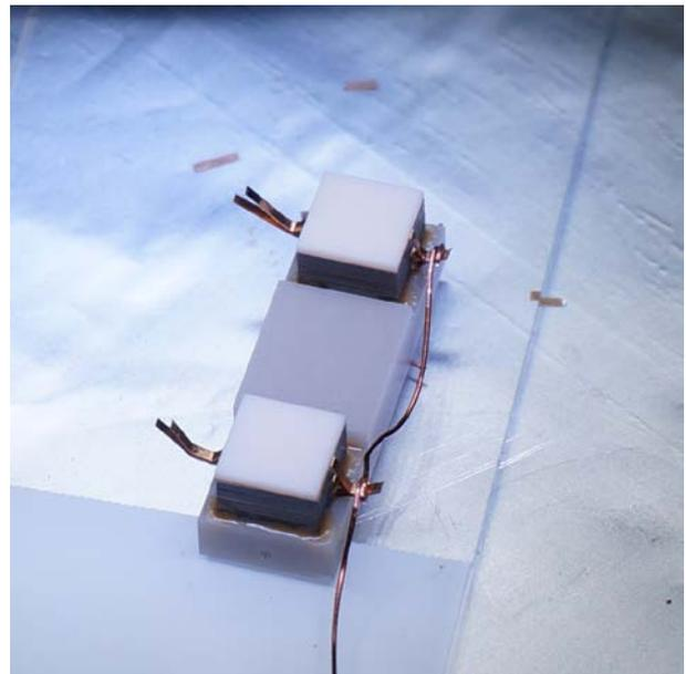
1.3.4. 超高真空対応ハンダ([Castolin Eutectic 157](#))で銅線をハンダ付けする。[専用フラックス](#)を用いる。
