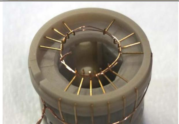
1.1.5. 溝と穴に [EPO-TEK H74](#) を塗る。EPO-TEK は新しいものを使うのが良い。粘度が低く、溝や穴に入り込むため。EPO-TEK は少しずつ何度かに分けて塗る。
