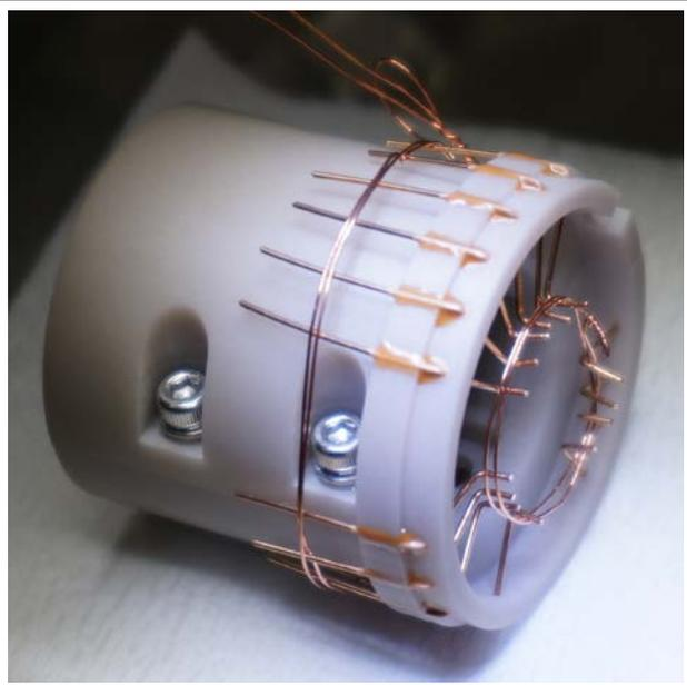
1.1.9. 底面のベリ銅線を切りそろえる。端子を使って長さの目安を得るとよい。端子は [AMP 2-330808-8](#)。
