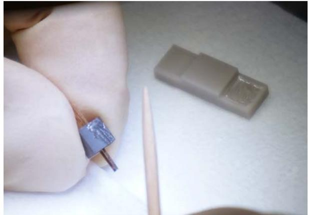
1.2.2. 写真は接着面だけでなく、積層ピエゾ素子の下部側面にも盛った後のもの。(1.2.4 参照)
