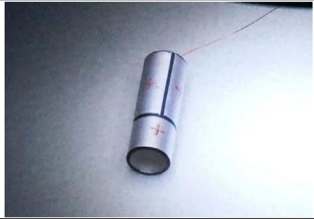
2.2.6. ピエゾチューブに探針ホルダーからのトンネル電流用同軸を通す。スキャナー台をはめる。
