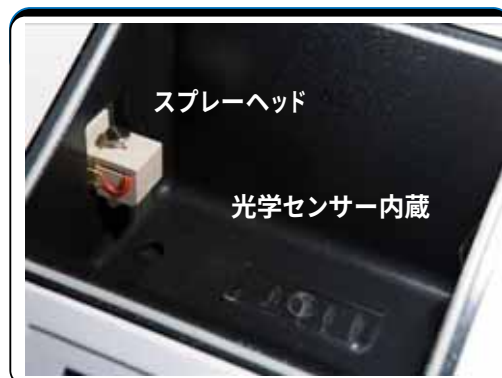
スプレーヘッド 光学センサー内蔵 テフロンコーティングスプレーチャンバー
