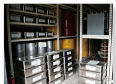
漏洩対策などの措置を行い保管している PCB 含有廃棄物
