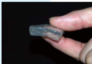
一度固まると、適度な強度を持ち型崩れしないアクアマテリアル
