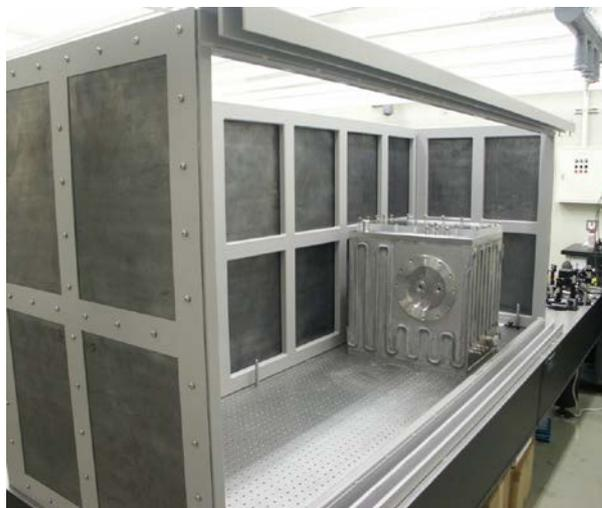
図2 光学定盤に設置したプラズマX線発生用チャンバーと鉛ハッチ
