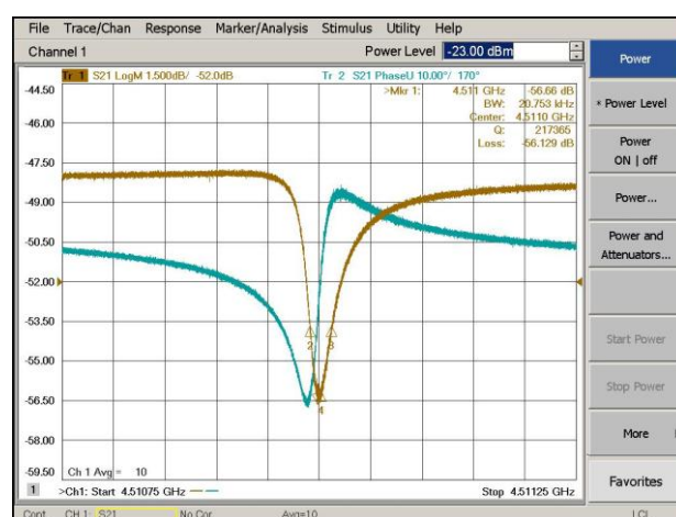
図 4 : 冷却試験で得られた共振ピークの例
